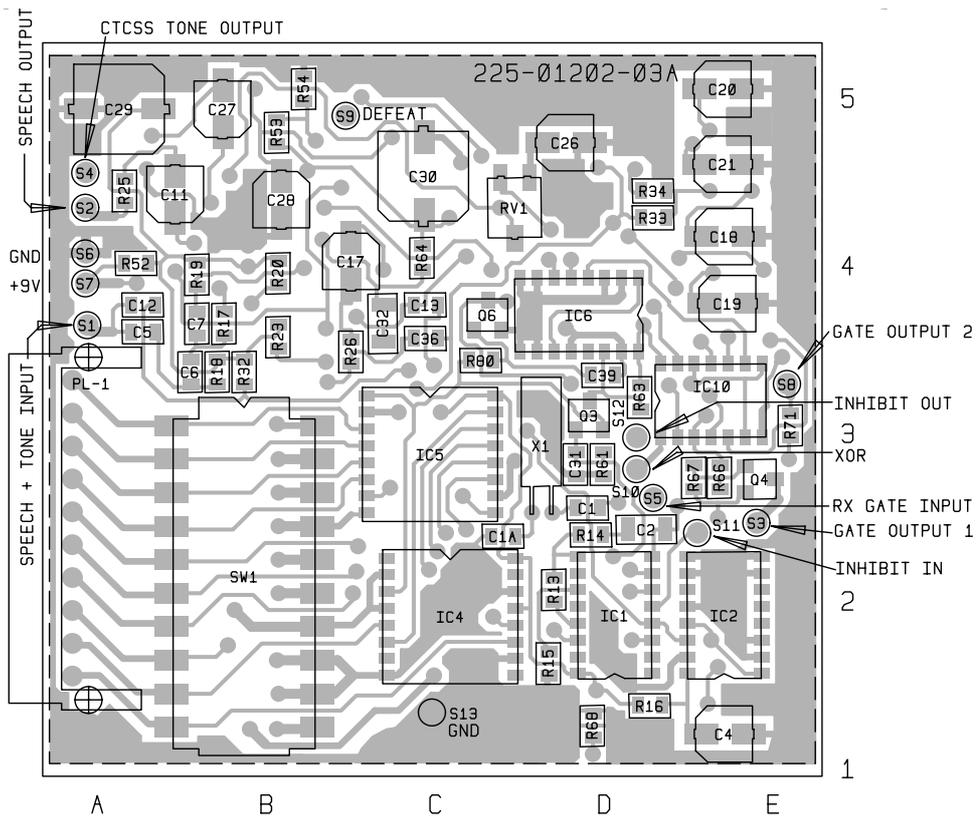
Figure 15 T800-02 PCB Layout - Top Side (IPN 225-01202-03)
