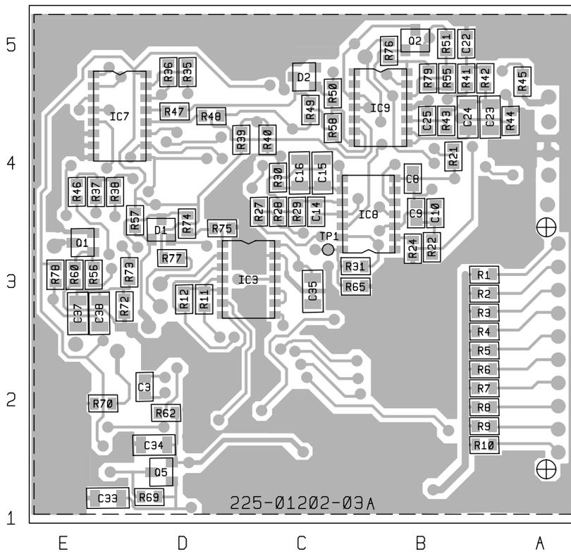
Figure 16 T800-02 PCB Layout - Bottom Side (IPN 225-01202-03)
